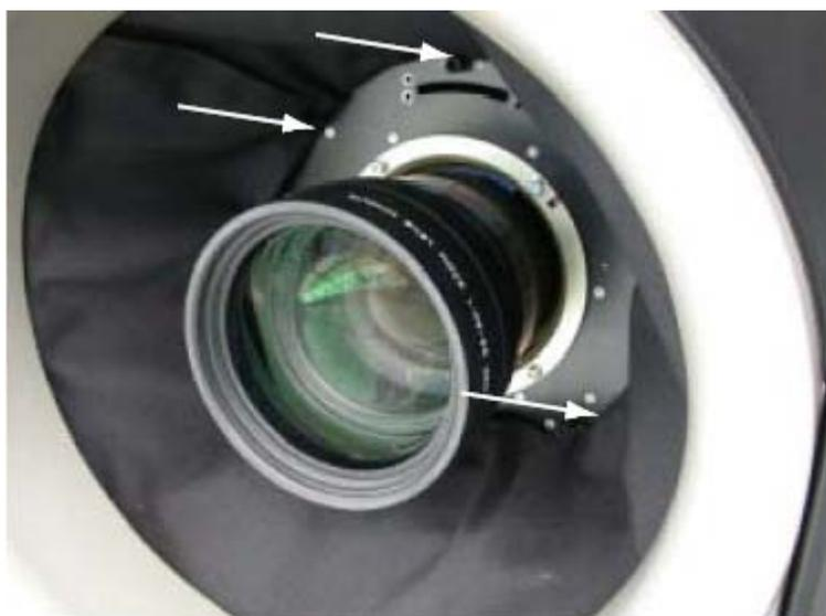
图9-4 拆卸防尘套
