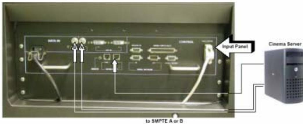
图4-1 电影服务器与放映机的连接
