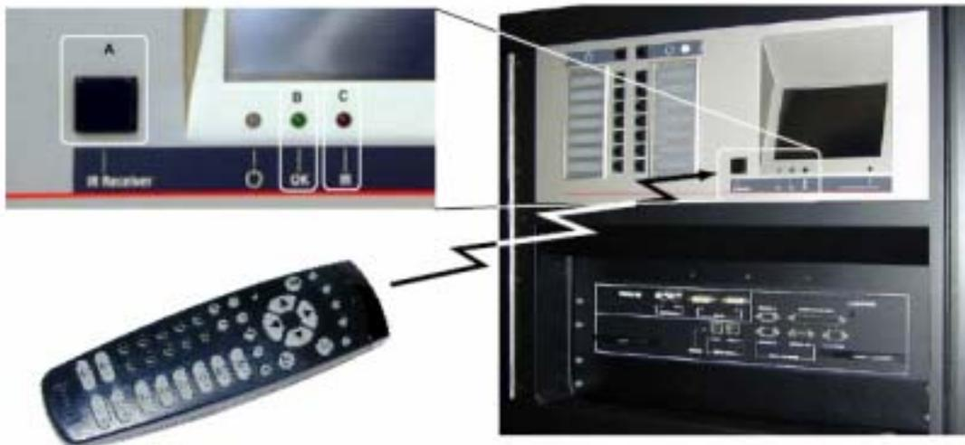
图5-4 将遥控前端指向窗口
