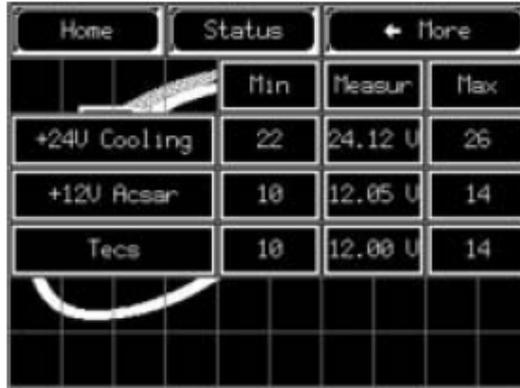
图 10-18 电压概览窗口3
